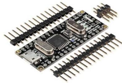
**Gambar 1** Mikrokontroler ATmega 328 SMD
