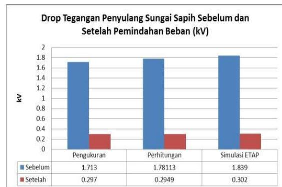
Gambar 8 Drop tegangan penyulang Sungai Sapih dalam kV
