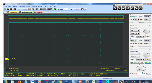
Gambar 14 Hasil pengujian terlihat bahwa THD 1% dengan fc 1KHz
