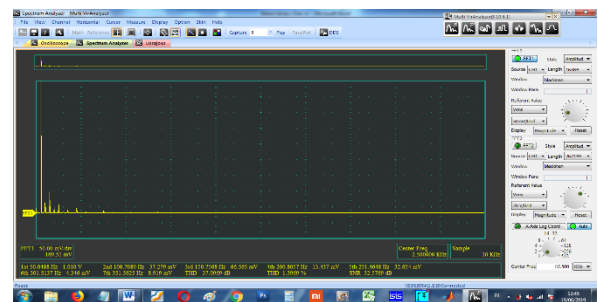
Gambar 13 Hasil pengujian (penyearah kontrol arus Ramp) terlihat bahwa THD 1.3%
