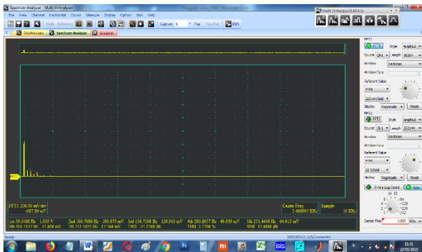
Gambar 15 Hasil Pengujian bahwa THD 2.7% dengan f_c 848 Hz
