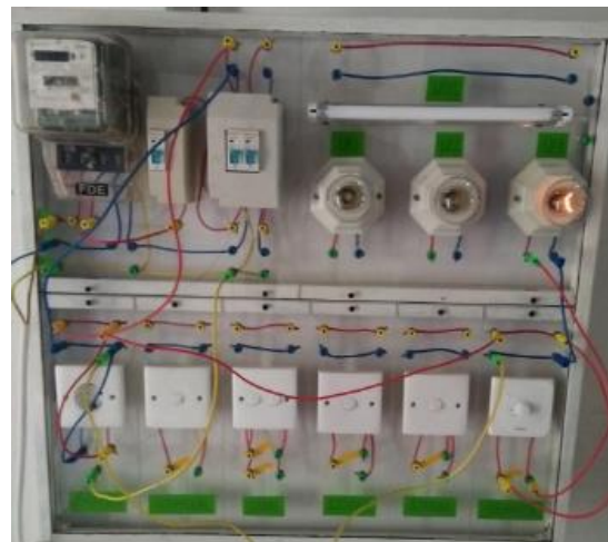
Gambar 20 Pemasangan satu saklar dimmer, satu lampu, satu stop kontak.
