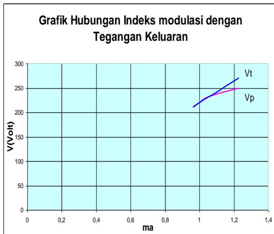
**Gambar 10** Karakteristik hubungan ma dan V beban resistif
