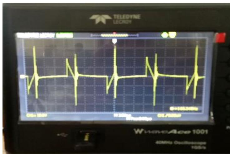
Gambar 4. Gelombang tegangan AC saat PWM 20%
