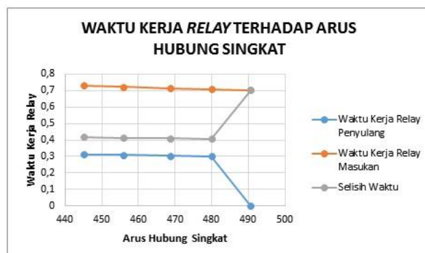
Gambar 2. Waktu Kerja Relay pada saat gangguan hubung singkat satu fasa ke tanah
