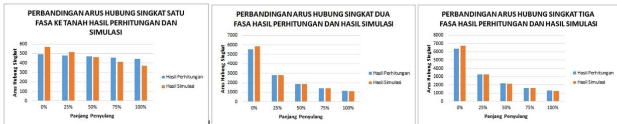
Gambar 4. Perbandingan arus hubung singkat satu fasa ke tanah, dua fasa ke tanah dan tiga fasa ke tanah
