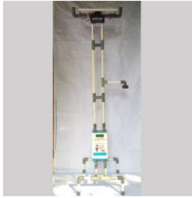
Gambar 4. Prototipe alat pemantau arus bocor
