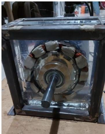
**Gambar 8.** Generator Magnet Permanen 1 Fasa Hasil Modifikasi Alternator
