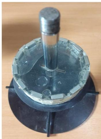
**Gambar 6.** Rotor Magnet Permanen untuk alternator modifikasi
